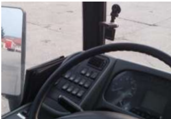
Obr. 7.1.1 Príklad umiestnenia kamery vo vozidle MHD
